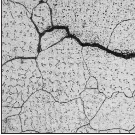
Şekil 5 - Heterojen bir kaynak bağlantısında % 25 Cr, % 20 Ni'li bir elektrod kullanılması ile oluşan erime bölgesi. Mikro çatlaklar östenit ağı boyunca uzanmaktadır.
