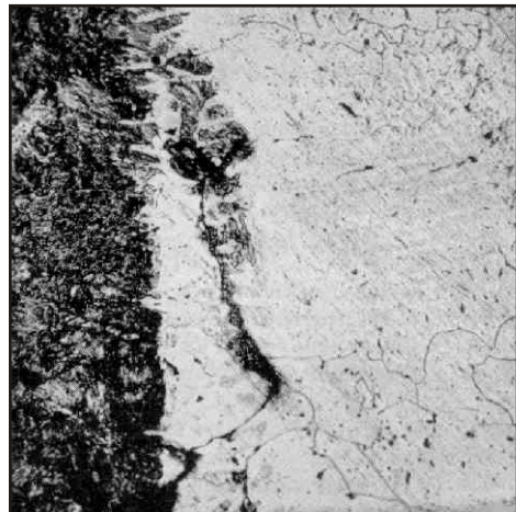
Şekil 7 - Havada su alabilen bir çeliğin % 20 Cr, % 10 Ni, % 3 Mo'li elektrodla kaynağı. Bağlantı bölgesinde, östenitik-ferritik yapı yerini çatlak oluşumuna elverişli östenitik yapıya terketmiştir.
